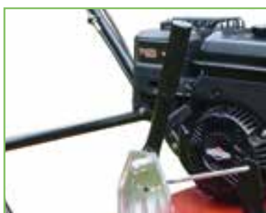
Regulación altura centralizada.
